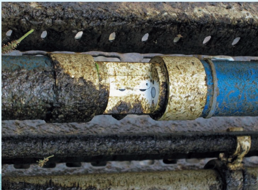
Ophoping van sediment kan de meting verstoren. Met een automatisch schoonmaaksysteem kan de sonde zijn werk blijven doen.
